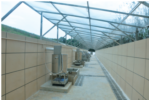
标准化径流小区自动观测站
