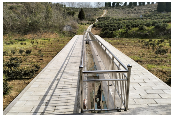
自然坡面径流小区配套巴歇尔槽监测设施
