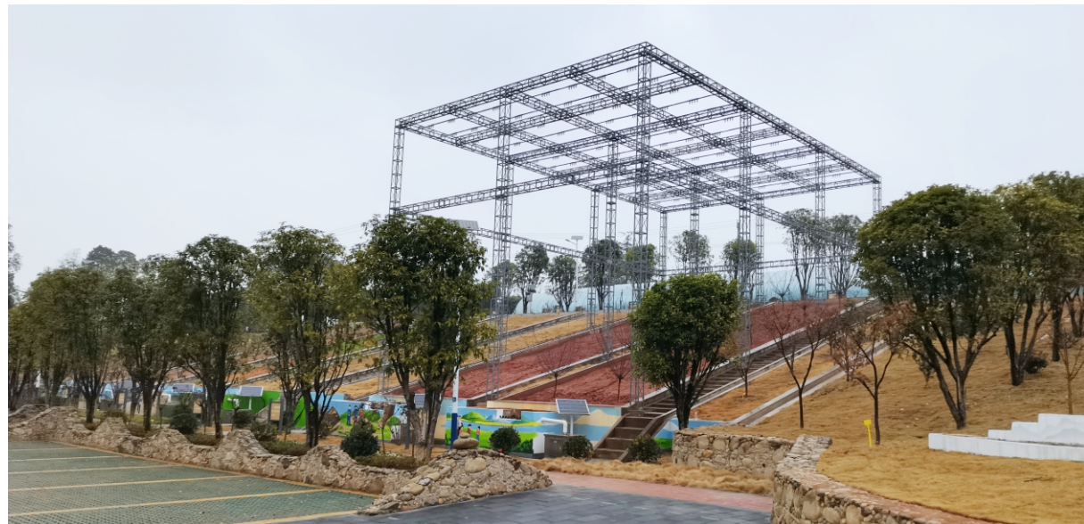
高腊梅港流域监测点坡面径流小区配套人工降雨设施设备
