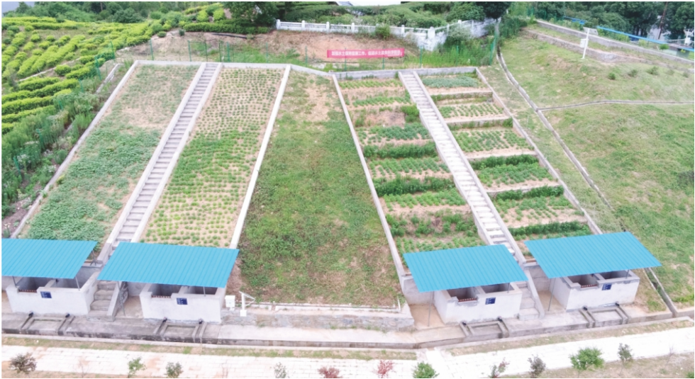
新建4个标准坡面径流小区全景
